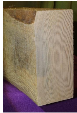
Bild 7: Kantholz herzförmige Baumkante Bläue im Splint
