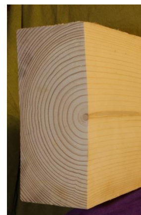
Bild 6: Kantholz – Halbholz Markröhre
