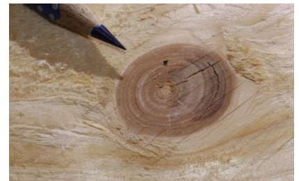
Bild 1: Gesunder festverwachsener Ast auf sägerauer Oberfläche
