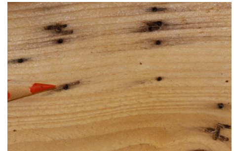
Bild 10: Fraßgänge vom gestreiften Nutzholzborkenkäfer mit 1-2 mm vom Pilz schwarz gefärbten Bohrgängen - Frischholzinsekt
