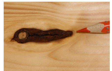
Bild 12: Rindeneinwuchs mit kleinem Ast
